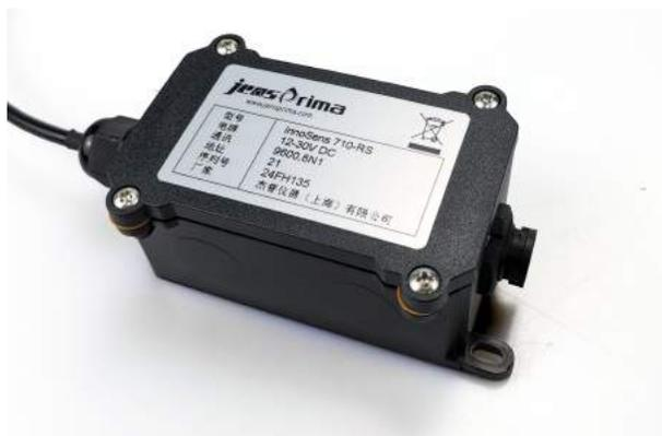
innoSens 710-RS 数字余氯/二氧化氯模块采用Modbus RTU标准协议将 innoSens 710双铂金电极转换为RS485串口信号, 无需控制器, 即可直接连到PLC或SCADA系统。可选配PT1000温度传感器, 内置pH值补偿, 测量更精确。
